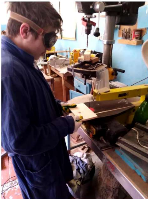
Электролобзик «STAVTOOL» Используется для резки деревянных заготовок.
